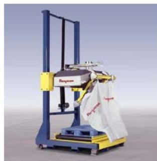
Když se celá plnicí hlava zvedá, rám pro připojení vaku se otáčí do horizontální polohy.
