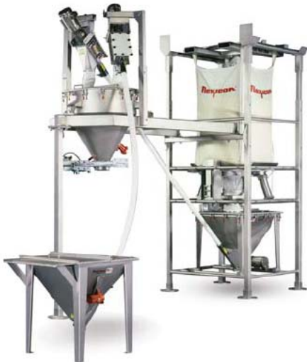
Tento systém dávkování hmotnostním přírůstkem umožňuje automatické vážení základních přísad dodávaných ve velkoobjemových vacích a doplňkových přísad naložených manuálně. Siloměry ústředního vážního zásobníku přenášejí informaci o přírůstku hmotnosti do regulátoru, který spouští a zastavuje dopravníky pro zvažení každého materiálu v sekvenci a spouští ventil hradítka pro vyprázdnění navážené dávky.
