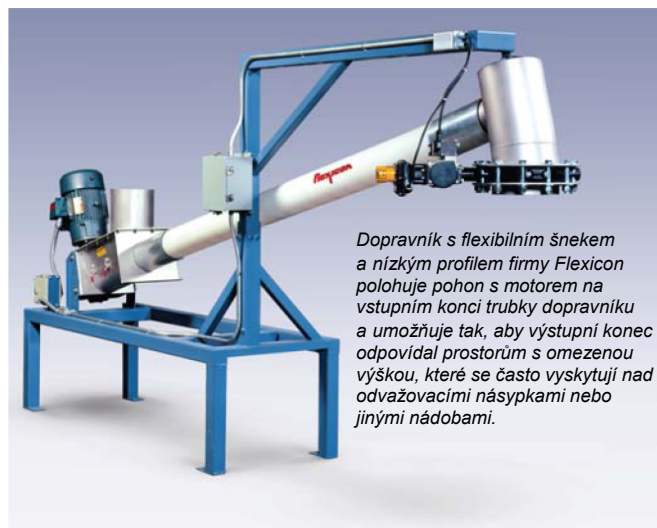
Firma Flexicon velké množství mechanického a pneumatického příslušenství násypky pro podpoření toku špatně tekoucích nebo obtížně tekoucích materiálů. Tato násypka má dvě míchadla se vzájemně blokovánými lopatkami, která rozmělní sypký materiál a usnadňují kontinuální plnění vstupních adaptérů mechanického dopravníku.
