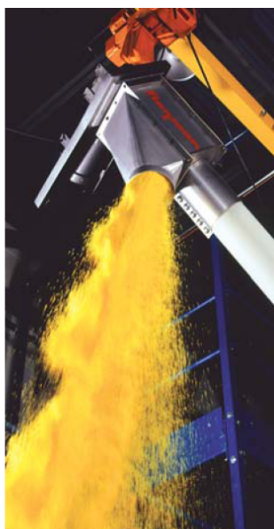
Dopravník s flexibilním šnekem o velké výkonnosti, z něhož je pro demonstraci toku materiálu demontovaný skluz.
