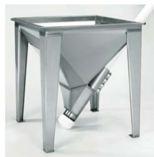
Konstrukce násypky s divergentními úhly a velkým průtokem patentovaná firmou Flexicon redukuje u nesnadno tekoucích materiálů možnost tvoření mostu mezi stěnami násypky, naopak nutí materiál spadat dolů a téci podél strmé zadní stěny, zvětšuje průtok sypkého materiálu a zmenšuje množství zbytkového materiálu v násypce.
