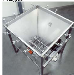
Firma Flexicon velké množství mechanického a pneumatického příslušenství násypky pro podpoření toku špatně tekoucích nebo obtížně tekoucích materiálů. Tato násypka má dvě míchadla se vzájemně blokovánými lopatkami, která rozmělní sypký materiál a usnadňují kontinuální plnění vstupních adaptérů mechanického dopravníku.
