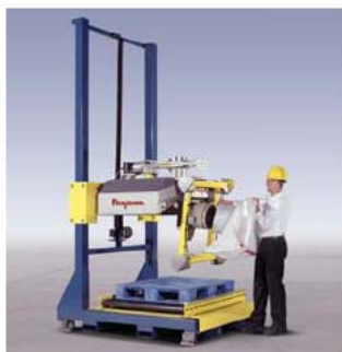
Obsluha stojící na podlaze připojuje výpust vaku k vertikálně orientovanému rámu pro připojení vaku.
