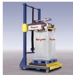
Rám pro připojení vaku se otočil do horizontální polohy, plnicí hlava je zvednutá do polohy „plnění vaku“ a vak je nafouknutý, aby se odstranily záhyby.
