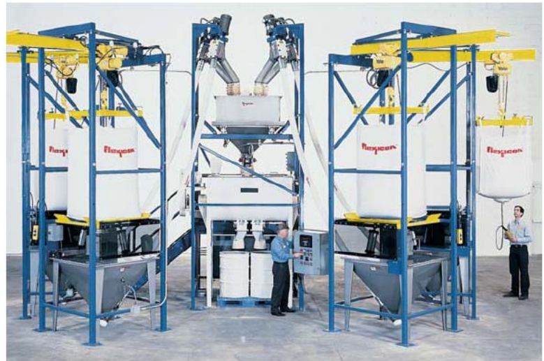
Tento systém dávkování hmotnostním přírůstkem dodávaný „na klíč“ dopravuje materiál ze čtyř vyklápěčů vaků na sypký materiál Flexicon do vážního zásobníku, který se vyprazdňuje do míchacího zařízení. V průběhu míchacího procesu je v zásobníku odvážena další dávka, čímž se redukují časy cyklů. V tomto případě se namíchané dávky vyprazdňují přímo do přepravních kontejnerů.
