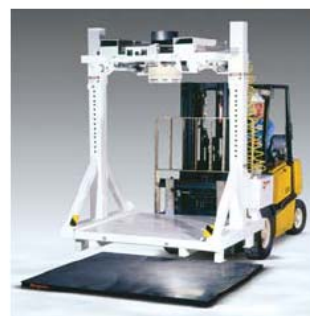
Tento rám TWIN-CENTERPOST se dá zvednout vysokozdvizným vozíkem na víceúčelovou provozní váhu, čímž se eliminují náklady na siloměry a ovládací prvky.
